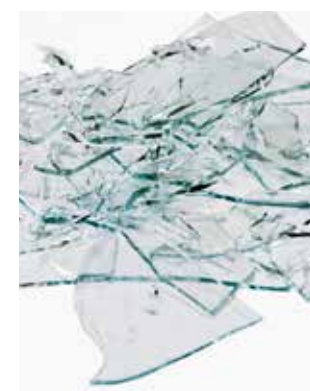
Rottura di un vetro non VSG
